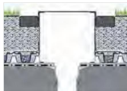
Sistema de cubierta verde intensiva con Caja de control KS 30/30-E instalada en la zona vegetal.
