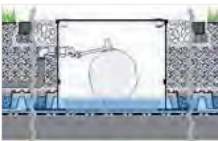
Sistema de cubierta verde intensiva con Floradrain® FD 60 neo con riego por aljibe controlado en cubiertas de 0° combinado con Automata de riego KB 30 de ZinCo.
