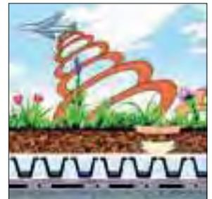
Las cubiertas vegetales aíslan acústicamente hasta 3 dB y son capaces de mejorar la insonorización hasta 8 dB, siendo una protección eficaz para edificios situados en entornos con alta contaminación acústica.
