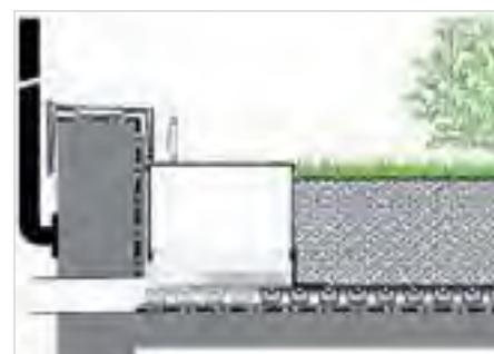
Sistema de cubierta verde intensiva con Caja de control AKS 8/30 en combinación con elemento elevador KSA 20/30. Se instala en un borde perimetral bajo con gárgola. Cubierta asegurada con barandilla.
