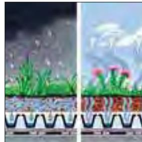
Las cubiertas vegetales son capaces de retener hasta el 90 % de la precipitación. Una buena parte de esta agua es devuelta a la atmósfera, el resto fluye de forma retardada a los sistemas de desagüe. Así se puede disminuir el dimensionado de los sistemas de desagüe y se reducen los costes asociados.
