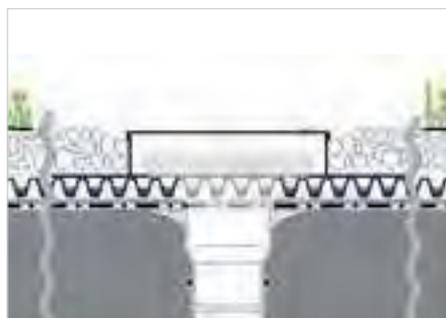
Sistema de cubierta verde extensiva con Caja de control KS 6/30 instalada en la zona vegetal.
