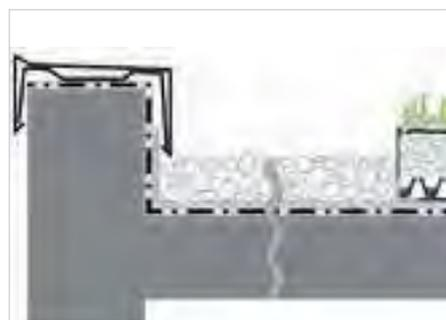
Sistema de cubierta verde extensiva con Perfil de separación KL 80/100 separando las áreas vegetadas de la franja de grava.
