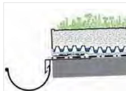
Sistema de cubierta verde extensiva con Perfil de alero DP 120 que sirve como borde perimetral de la cubierta verde.
