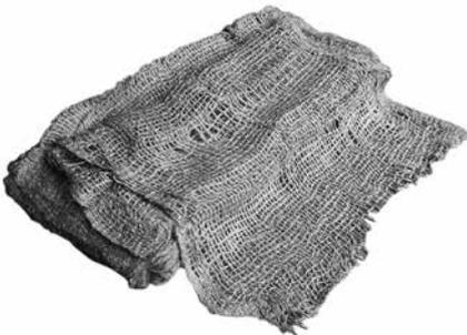
Tejido pesado de malla gruesa de 100 % de yute, que evita la erosión por viento y agua sobre superficies recientemente cubiertas con humus; el yute es biodegradable al 100 %; aplicable en cubiertas inclinadas ajardinadas, en taludes, pendientes y orillas, etc. Por motivos medioambientales, el tejido de yute no está tratado para inhibir las llamas. Por esta razón hay que protegerlo contra el fuego abierto o brasa. Peso: aprox. 500 g/m<sup>2</sup>; ancho de mallas: aprox. 3 cm × 4 cm.
