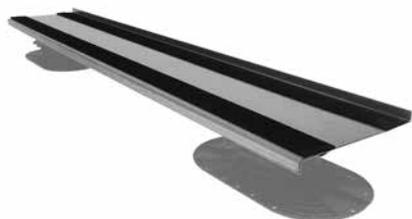
Al colocar las losas en bordes que no están en ángulo recto con la dirección de colocación del pavimento, se usa el elemento de soporte a inglete para bordes Elefeet®. El perfil, de una anchura de 170 mm, se coloca paralelo al borde sobre el Elefeet® y sirve para apoyar recortes de losas que queden muy pequeños. El canto continuo de una altura de 15 mm, delimita el pavimento. Con el engomado aplicado se consigue el apoyo antideslizante de las losas.
