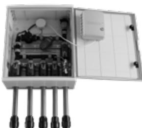
Unidad principal premontada especialmente diseñada para el riego automatizado de cubiertas verdes; en caja de plástico con cerradura; medidas aprox. 60 x 50 x 23 cm. Contiene válvula principal, conexión para el suministro de agua con tubería de 32 mm, filtro, regulador de presión, válvula de ventilación, conector para manguera de jardín, compresor, controlador de tiempo de riego con batería, 4 electroválvulas de 1" con conectores para tubería de 32 mm y sensor de lluvia.
