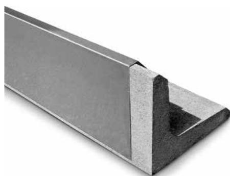
Perfil embellecedor para la pieza angular de hormigón, fabricado de chapa de acero inoxidable, canteado, recubierto con lámina, altura 24 cm, para que se pueda usar en los dos sentidos de colocación de la pieza (con el lado de 25 o el de 30 cm en vertical); longitud del perfil 200 cm con conector de juntas integrado. Esquinas interiores y exteriores del embellecedor prefabricadas a petición. Peso: aprox. 5,0 kg.
