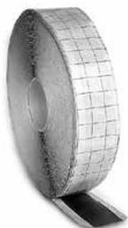
Cinta adhesiva especial para pegar láminas y telas filtrantes a fondos bituminosos, placas escurridizas o a hormigón (hormigón imprimado); adhesiva por ambos lados. !Pensada únicamente como ayuda para el montaje, la unión no es resistente a las raíces! Temperatura de elaboración aprox. 20 °C.
