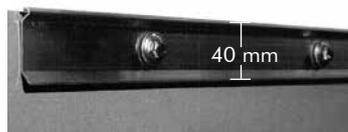
Perfil de fijación para sujetar láminas antirraíces o láminas de estanques a bordes o jardineras de hormigón, etc.; fabricado de aluminio natural; prensado por extrusión; preperforado cada 20 cm aprox.; altura del perfil: 4 cm.
