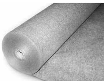
Filtro de polipropileno precomprimido y termosoldado; resistente a la descomposición; se utiliza como manta filtrante sobre elementos de drenaje para una tensión y estiramiento normal; permeabilidad ( $H_{50}$ ) según normativa EN ISO 11058: aprox. 70 l/(m<sup>2</sup> × s); abertura de poro ( $O_{90}$ ) según normativa EN ISO 12956: aprox. 95 μm; clase de resistencia 2; peso: aprox. 100 g/m<sup>2</sup>.
