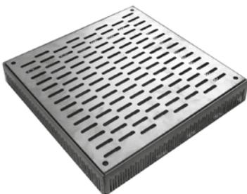
Rejilla de terraza estéticamente atractiva, regulable en altura entre 6,5–9,5 cm aprox.; se regula con un destornillador desde la tapa superior; tapa con ranuras alargadas adaptada al aspecto de la canaleta BTR.
