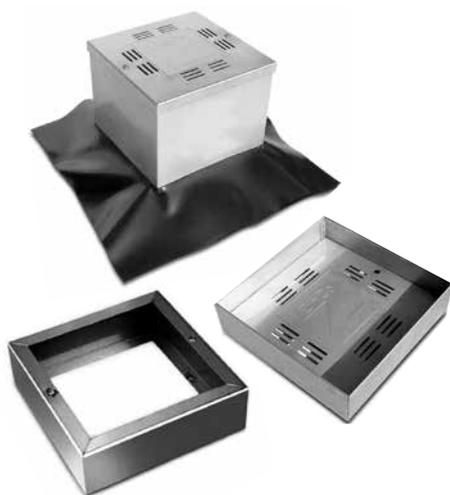
Caja de control de alta calidad, fabricada en **acero inoxidable (V2A)** con perforaciones en todo su contorno para absorber el agua del drenaje; la tapa se puede fijar mecánicamente, resistente a las pisadas con aberturas para la entrada del agua y con solapes de lámina adaptables en altura para el empalme con el filtro del sistema. Color: acero inoxidable natural; peso: aprox. 4,0 kg; medidas exteriores de la caja: 30 cm × 30 cm aprox.; medidas de la abertura interior: 24 cm × 24 cm aprox.
