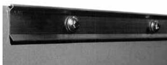
Perfil de fijación elegante, p.ej. para fijar láminas antirraíces o bandas para estanques en piletas de hormigón, piedras angulares, etc.; fabricado en aluminio natural; prensado por extrusión; preperforado con una separación entre agujeros de 200 mm aprox.; altura del perfil: aprox. 40 mm.
