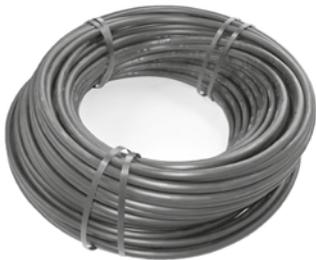
Tubería por goteo con goteros de compensación de presión integrados, para el riego en cubiertas verdes en combinación con el filtro de distribución de agua AF 300; diámetro exterior de la tubería: aprox. 16,0 mm con goteros integrados en la tubería, distancia entre goteros aprox. 500 mm, capacidad de goteo aprox. 1,6 l/h; compensación de la presión: entre 0,4 y 2,5 bares.
