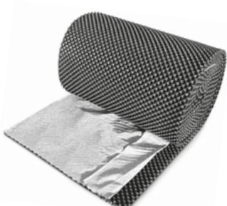
A fin de poder colocar estructuras de ajardinamiento con Floradrain® FD 25 de modo especialmente rápido, se puede adquirir en forma de rollos con el filtro de sistema **ZinCo** incorporado. Estos rollos tienen un solape de filtro por un sólo lateral de unos 10 cm. ¡Pero hay que tener en cuenta el mayor volumen de transporte de los rollos en comparación con las placas! Material: poliolefina reciclada (principalmente PE) embutida a profundidad.
