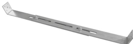
Espaciador variable para mantener una separación entre 350–625 mm, con tacos en relieve para encaje anti-torsión. Espaciador variable de acero galvanizado o bajo pedido se puede suministrar en acero inoxidable.
