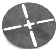
La arandela distanciadora de caucho de un espesor de 1 mm se coloca sobre el Elastoring, para compensar ligeras diferencias de alturas. La arandela distanciadora puede servir de seguro antideslizante puesta sobre la cabeza de los soportes Elefeet®.
