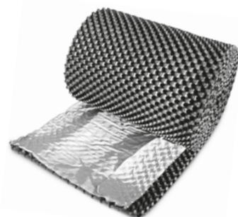
A fin de poder colocar estructuras de ajardinamiento con Floradrain® FD 40 de modo especialmente rápido, se puede adquirir en forma de rollos con el filtro de sistema ZinCo incorporado. Estos rollos tienen un solape de filtro por un sólo lateral de unos 10 cm. ¡Pero hay que tener en cuenta el mayor volumen de transporte de los rollos en comparación con las placas! Material: poliolefina reciclada (principalmente PE) embutida a profundidad.
