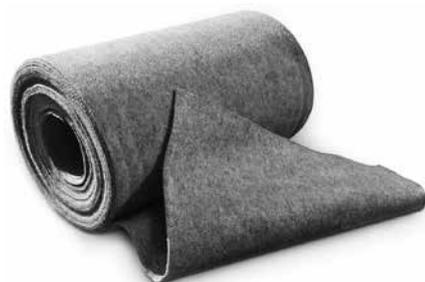
Bandas protectoras de fibras de poliéster previstas para el uso en bordes de cubiertas y de conexión, apropiadas especialmente para la combinación con Fixodrain® XD 20. Como ayuda para el montaje, pulverizada con adhesivo por el reverso; resistente al betón; química y biológicamente neutral; grosor: aprox. 3 mm; peso: aprox. 320 g/m<sup>2</sup>.
