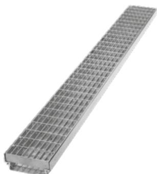
Canaletas para fachadas con altura de 40 mm y anchura de 100 mm, fabricadas en aluminio prensado por extrusión, con rejilla transitable fabricada en acero galvanizado al fuego y ancho de malla 33 mm × 11 mm.
