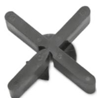
Separador de juntas, grosor 5 mm aprox.; altura 11 mm aprox.; fabricado de plástico resistente a la descomposición; para la rápida y fácil colocación de pavimentos de losas sobre un lecho de gravilla con una precisión duradera; cuarta pata del separador de fácil extracción, sin necesidad de herramientas.
