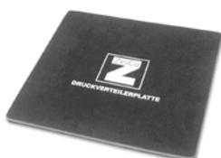
Se coloca la placa distribuidora de la presión directamente debajo del Elastoring para proteger el nivel de impermeabilización de altas cargas puntuales y los correspondientes daños. Con la placa de 200 x 200 mm de goma se eleva la estructura en aprox. 4 mm.
