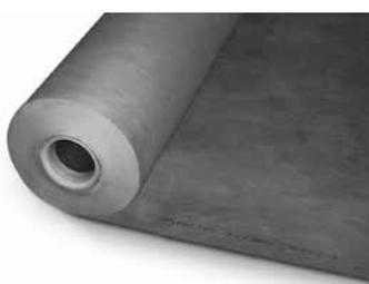
Filtro de polipropileno endurecido térmicamente **con gran resistencia a las cargas mecánicas**; aplicable especialmente sobre terraplenes de drenaje; permeabilidad ( $H_{50}$ ) según normativa EN ISO 11058: aprox. 40 l/(m<sup>2</sup> × s); abertura de poro ( $O_{90}$ ) según normativa EN ISO 12956: aprox. 85 μm; clase de resistencia 3; peso: ≥ 175 g/m<sup>2</sup>.
