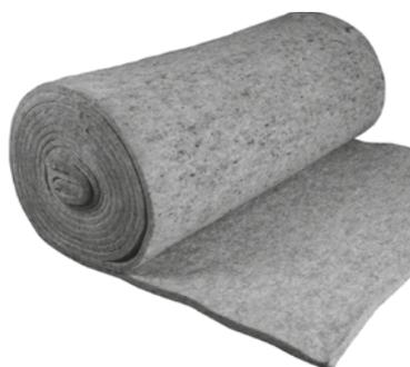
Manta de fibras sintéticas, termofijada, punzonada; no degradable; útil como manta retenedora bajo ajardinamientos extensivos, especialmente para cubiertas inclinadas; compatible con betún; química y biológicamente neutral; resistente al desgarró; fabricada con fibras sintéticas recicladas. **Capacidad de retención de agua: aprox. 12 l/m<sup>2</sup>; grosor: aprox. 17 mm; peso: aprox. 1500 g/m<sup>2</sup>.**
