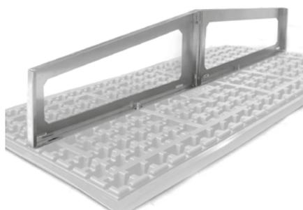
Set de fijación para la instalación del soporte SB200-4 y dos soportes de base SGR para crear una instalación solar con orientación este-oeste. Para esta subestructura se requieren dos soportes de base solar, n° art. 9700xx y una Base Solar SB 200-4, n° art. 3465. La subestructura se puede realizar de forma que los bordes se unan en el centro en un punto más alto (forma a dos aguas) o más bajo (forma en mariposa). Material: acero inoxidable.
