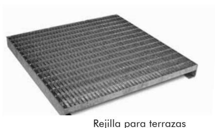
Se pueden colocar rejillas para terrazas fabricadas de acero galvanizado al fuego, con ancho de malla aprox. 44 × 11 mm, en lugar de las losas de hormigón de pavimento, cuando nos encontremos encima de los desagües de la cubierta o bien con la ayuda de brazos-soporte a lo largo de la fachada y se hace posible un paso rápido del agua pluvial por el espacio que hay debajo del pavimento.
