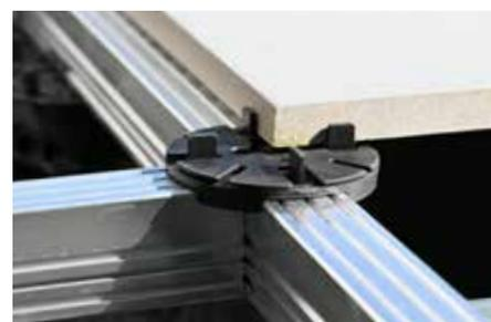
La placa de soporte con separadores de juntas integrados firmemente atornillada al sistema de rieles de soporte evita que las losas se deslicen.
