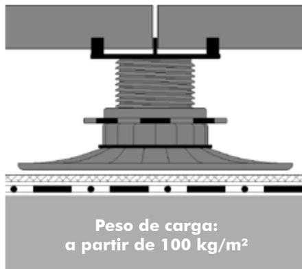
Pavimento (hormigón, piedra natural, cerámica, o bien láminas de madera) \*
