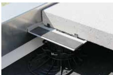
En los cantos, el soporte para bordes brinda estabilidad evitando que las losas se tambaleen. Los separadores para juntas disponen de ranuras, integradas en la placa superior del soporte elevador, asegurando un patrón uniforme de las juntas.
