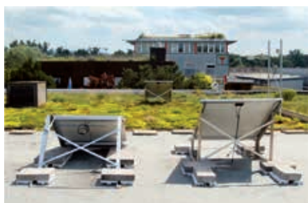
Se midió la diferencia de temperatura de distintos sistemas de cubiertas experimentales durante un año en las instalaciones de ZinCo.
